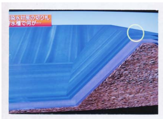
写真③ 福島原発貯水槽の遮水工
